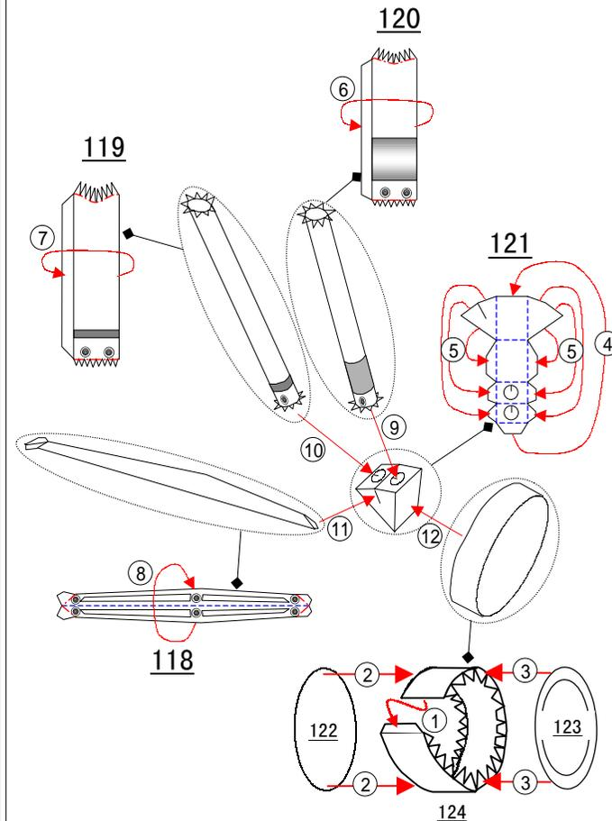
**3. 車輪を付けるときに組み立てます。車輪を付けないときは不要です。**
