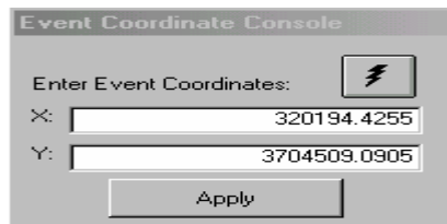
شکل ۱۴- نمونه‌ای از پنجره تعیین محل رخ دادن حادثه ریلی که هم با وارد کردن مختصات و هم از طریق انتخاب محورهای روی صفحه تصویر امکان پذیر می‌باشد.
