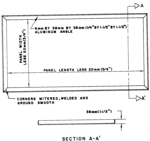
FIG. 1 Sag Test Frame
