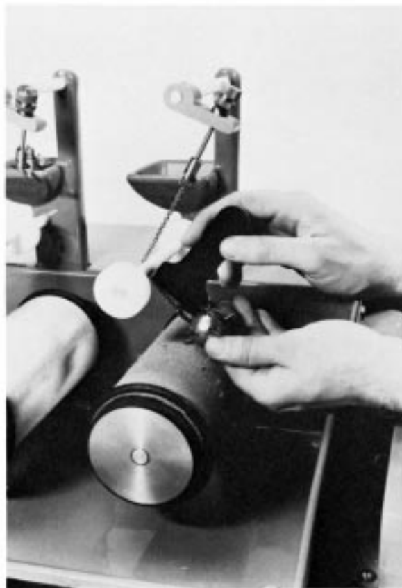
FIG. 6 Adjusting Mace on ICI Snag Tester
