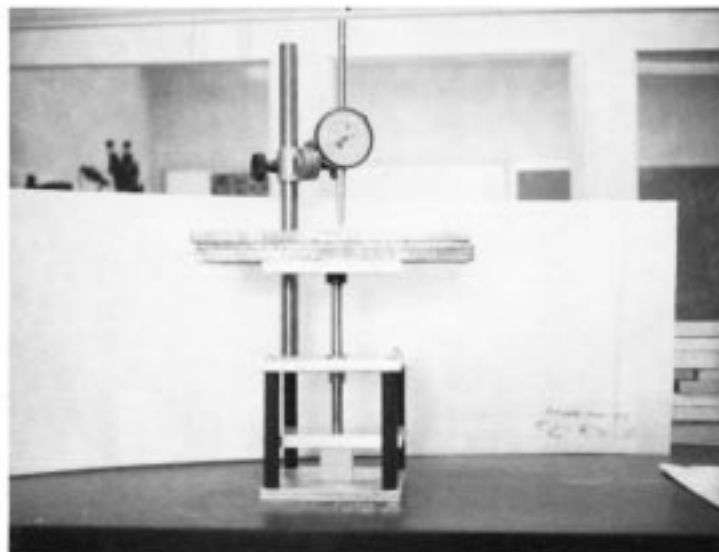
FIG. 2 Creep Test Apparatus
