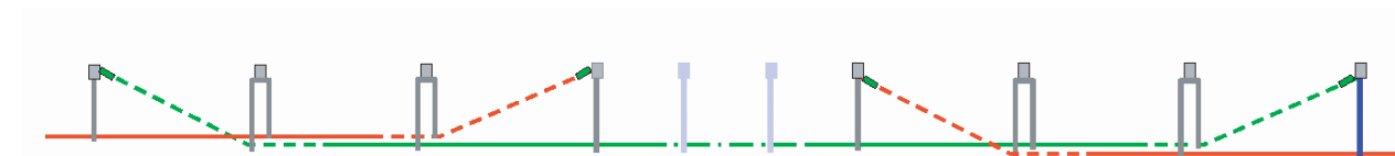
Fig. 13 - Neutral section - Section de séparation - Schutzstrecke
