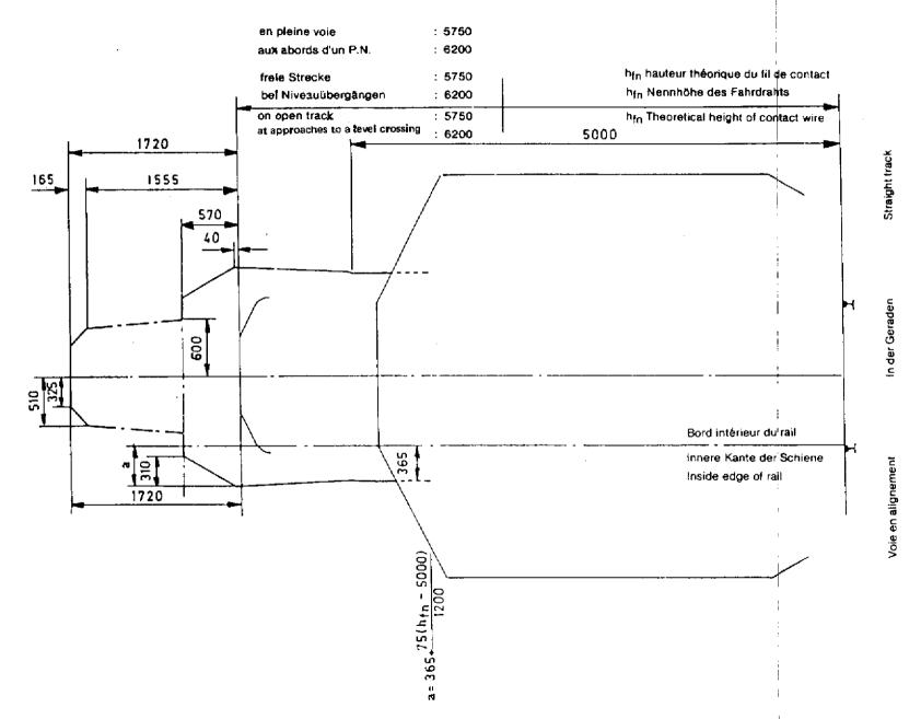
ESPACE POUR LA STRUCTURE LONGITUDINALE DE LA CATENAIRE 25 kV, 50 Hz Exemple de la SNCF RAUEM FUER DAS LAENGSKETTENWERK 25 kV, 50 Hz Am Beispiel der SNCF SPACE FOR LONGITUDINAL STRUCTURE OF CATENARY 25 kV, 50 Hz SNCF Exemple
